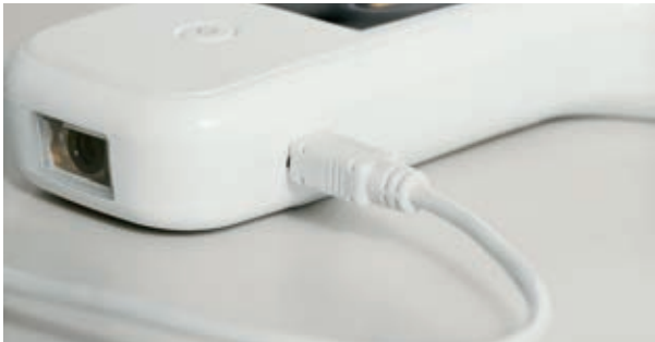
Datenmanagement-/USB-Anschluss für die Übertragung von Patienten-/QK-Ergebnissen
